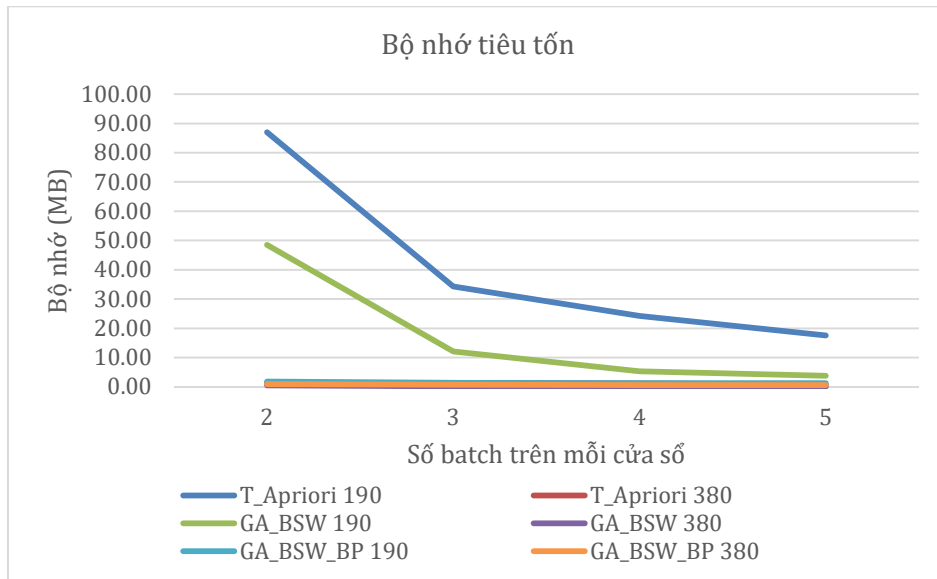
Hình 11. Biểu diễn bộ nhớ tiêu thụ ở bộ dữ liệu Chess giữa T_Apriori, GA_BSW và GA_BSW_BP
